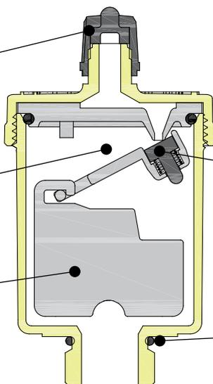
**Dispositivo di espulsione aria:** azionato mediante la rotazione del leveraggio a cui è collegato il galleggiante. Funzionamento automatico garantito fino al valore massimo di **4 bar** di pressione del circuito.
